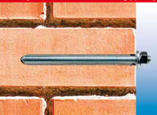
Przekrój zamocowania w murze z cegły pełnej
